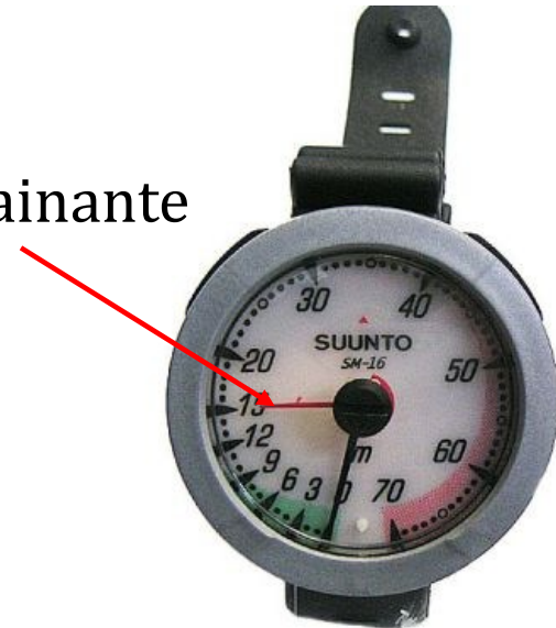
Profondimètre à aiguilles “à tube de Bourdon”
